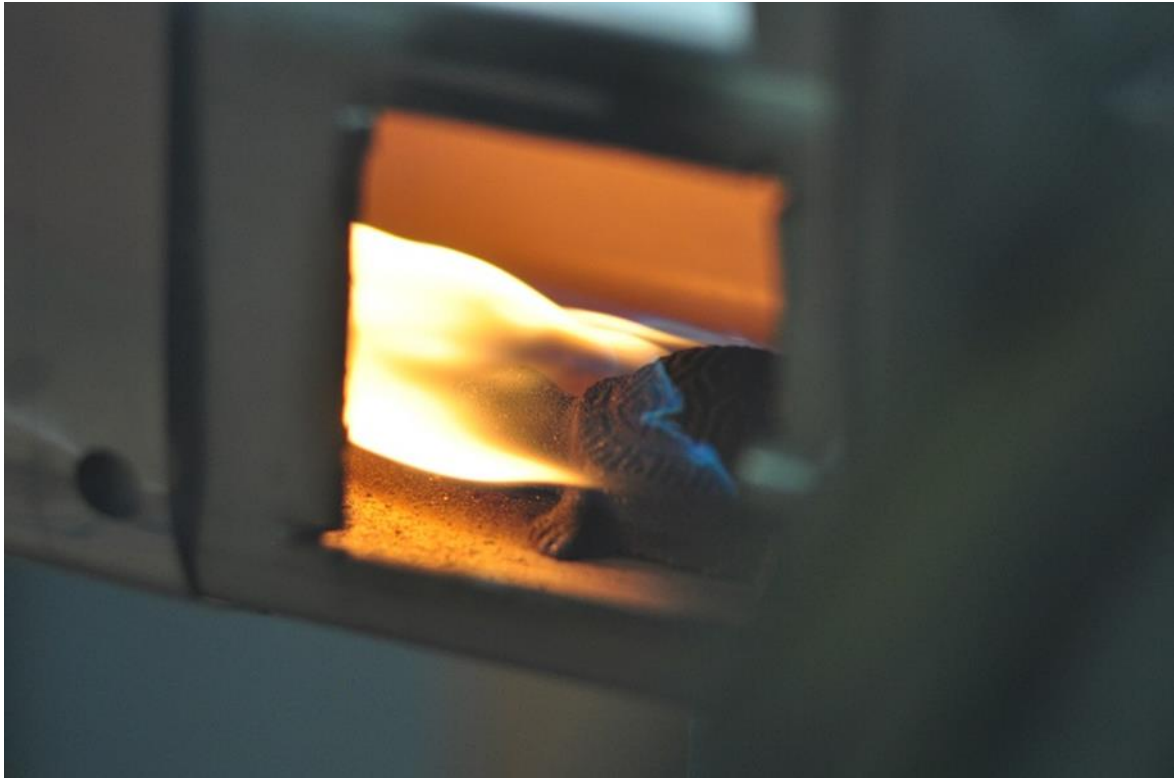
სურათი 3. საავტომობილო გვირაბის ფიზიკური მოდელი, ხანძრის კერა მსხვილი პლანით.
