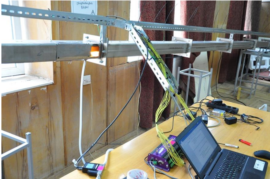
სურათი 1. საავტომობილო გვირაბის ფიზიკური მოდელი საზომი და საკონტროლო მოწყობილობებით, ცენტრალურ ნაწილში ჩანს ხანძრის კერა, იმიტირებულია დახრილი გვირაბი.
