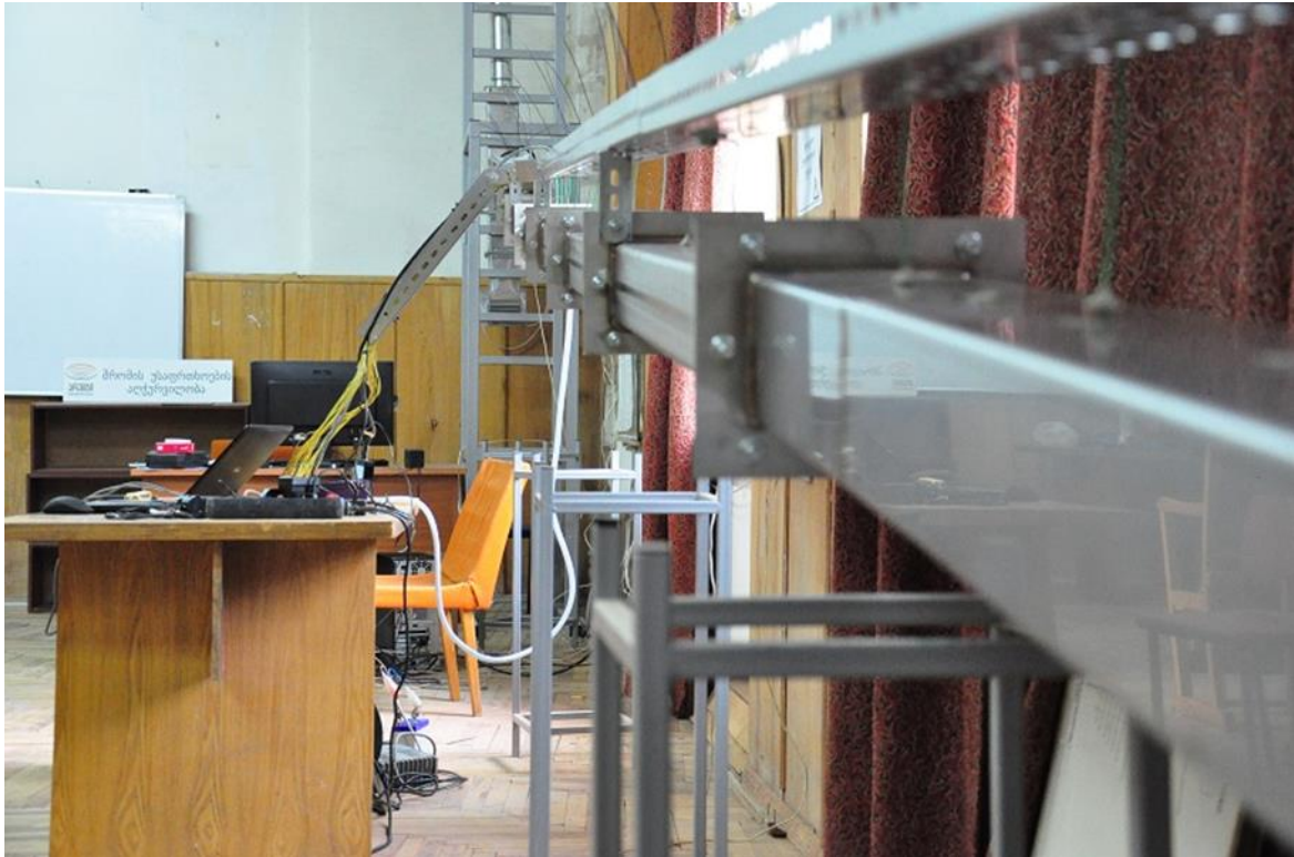
სურათი 2. საავტომობილო გვირაბის ფიზიკური მოდელი, ბოლოში ჩანს კიბეების ფორმის ასაწევ-დასაწევი მოწყობილობა.
